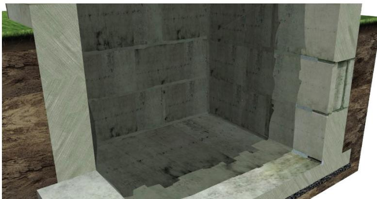
Рисунок 6. Нанесение на поверхность гидроизоляции БауБерг 430/2, не менее двух слоев толщиной 3 мм
