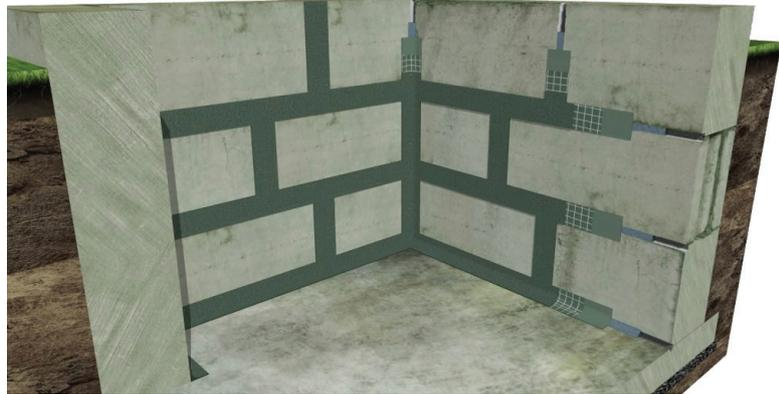
Рисунок 4. Нанесение гидроизоляции BauBerg 430/2 с армированием мелкоячеистой стеклосеткой (5x5 мм) после обработки швов (см. рисунок 2). Прилегающие к швам поверхности захватываются на 100 мм в каждую сторону
